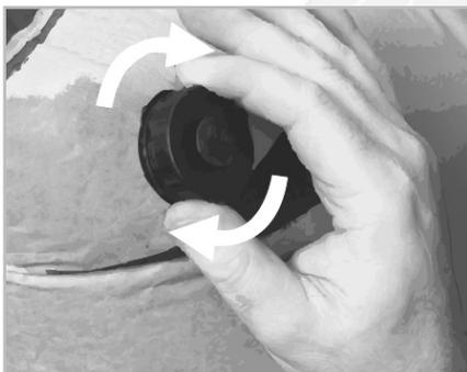
4. Nehmen Sie die Pistole heraus und befestigen Sie die Verschlusskappe. Stellen Sie sicher, dass die Verschlusskappe fest verankert ist.
