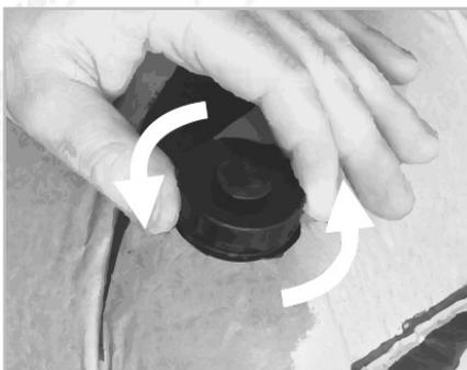
7. Öffnen Sie die Verschlusskappe zum entleeren.
