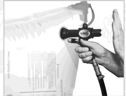
3. Aufblasen: Wenn Luft von hinten aus die Pistole kommt, ist der gewünschte Druck erreicht.
